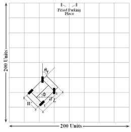
FIG 1. NON-HOLONOMIC WHEELED MOBILE ROBOT MODEL.
