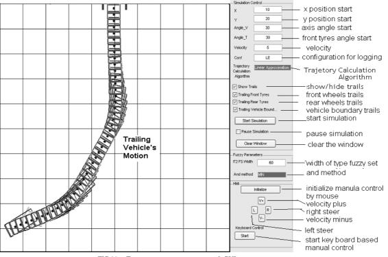
FIG 11. TRAILING MOTION SIMULATION & GUI OPTIONS DETAILS
